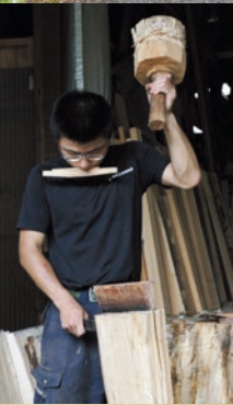
屋根板加工の様子
